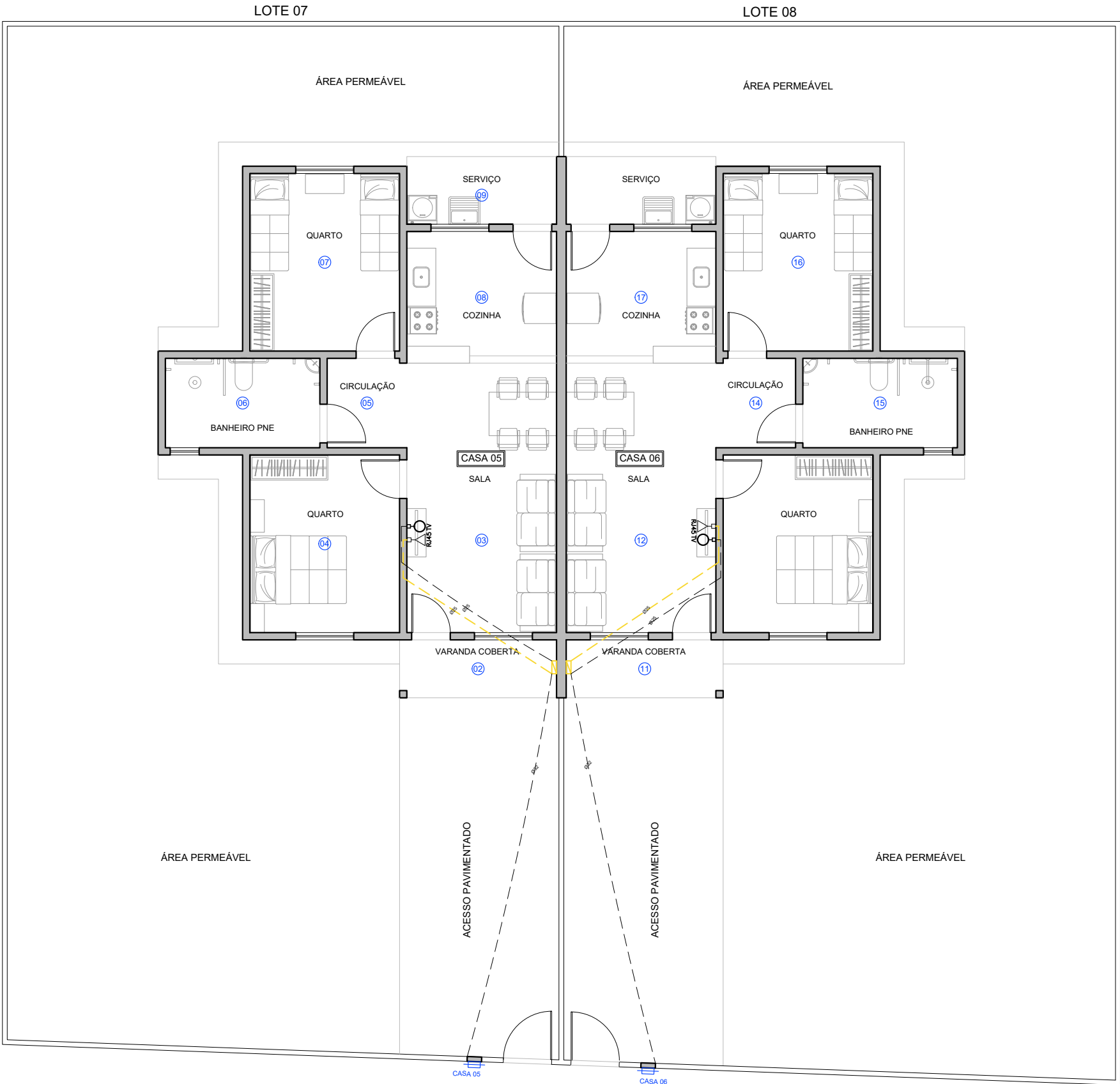
12 PLANTA CIRCUITOS DE TV E REDE LÓGICA - CASA COM ACESSIBILIDADE Esc: 1/100
