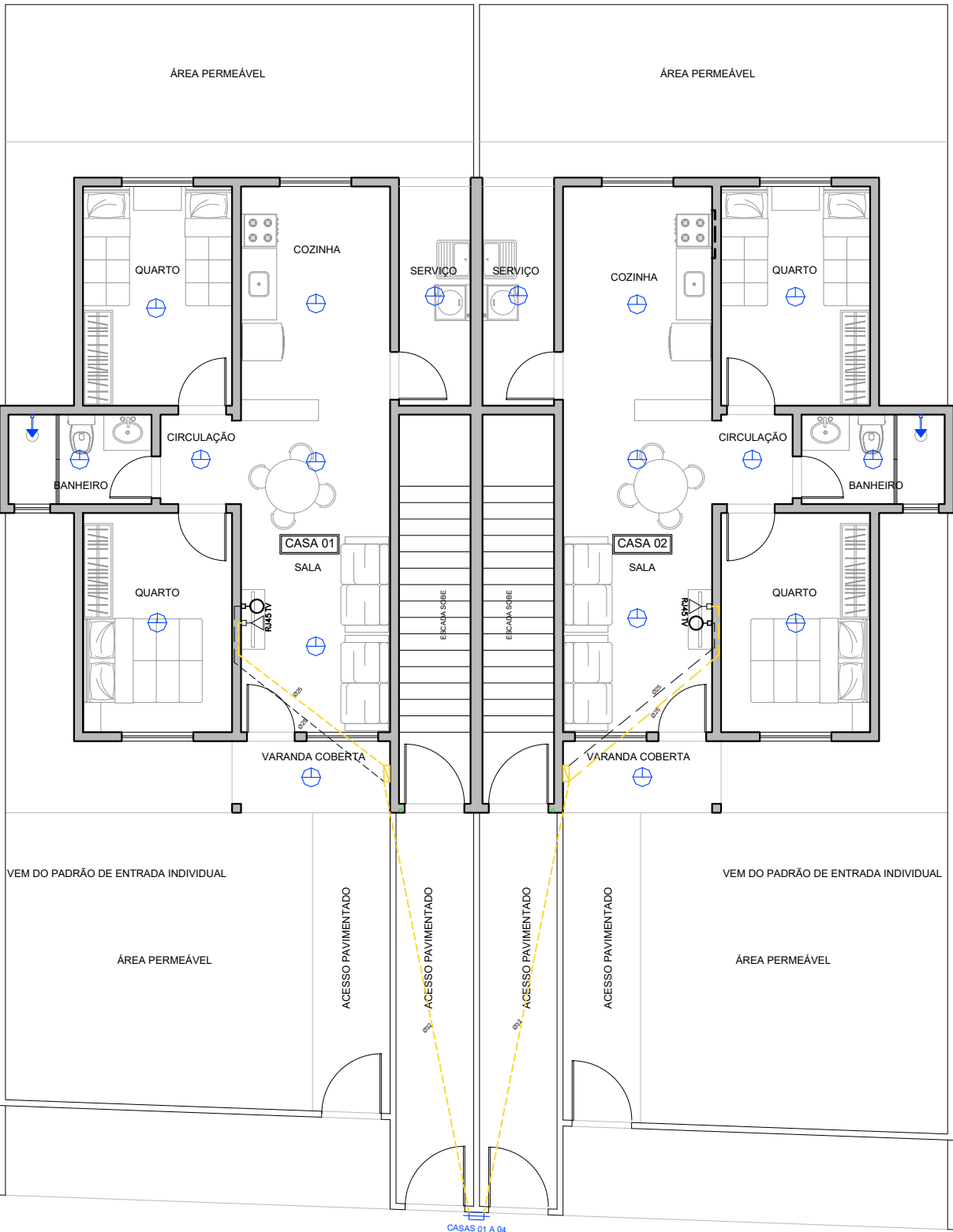
10 PLANTA CIRCUITOS DE TV E REDE LÓGICA - PAV. TÉRREO - CASAS 01 E 02 Esc: 1/100
